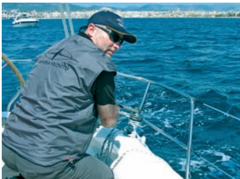
Die achtern plazierten Genuawischen machen das Boot einhandauglich – sind für Crewmitglieder aber nur mit dem Rücken zum Segel zu bedienen
