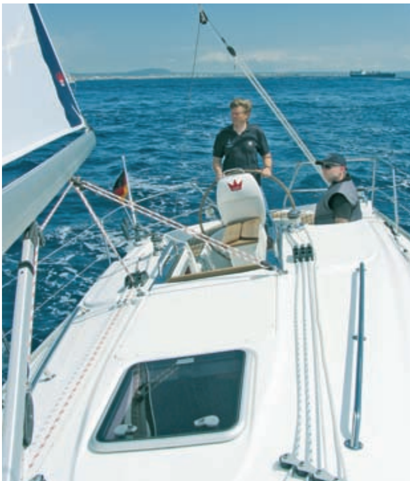
Fallen und Strecker sind ins Cockpit umgelenkt – das Großschotsystem kommt ohne Traveller aus
